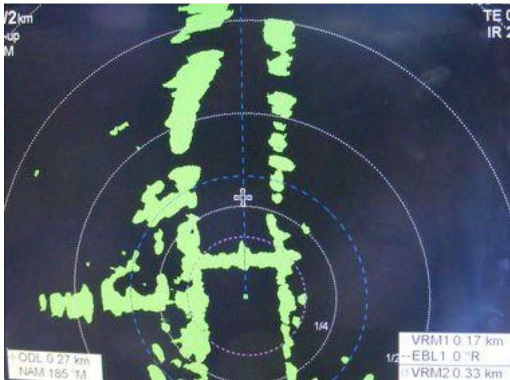
Rys.1a. Obraz radarowy mostu G. Źródło: opracowanie własne
